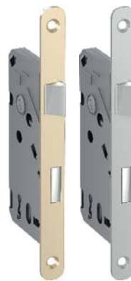
Schloss PRIME: Stirnfläche silber oder gold in Kollektionen mit Kunststoff- furnier Schlossfalle in Farbe matt verzinkt in Kollektionen mit Holz- furnier Schlossfalle in Farbe silber poliert
